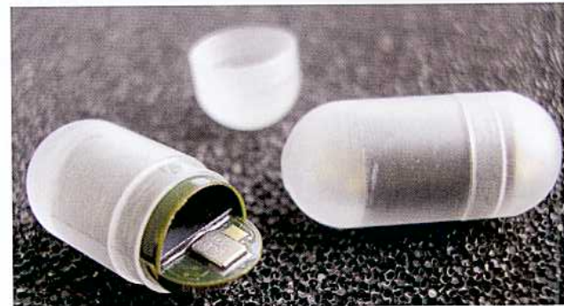
↑ Prototype de pilule électronique miniature intégrant un capteur de température et un module de communication sans fil.
